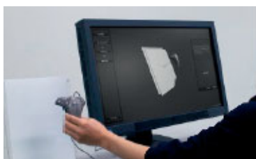
Měření souřadnic bílého bodu přímo z tisk. papíru pomocí senzoru EIZO EX1.
