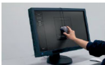
Automatická HW-kalibrace monitoru a uložení výsledku včetně ICC-profilu.
